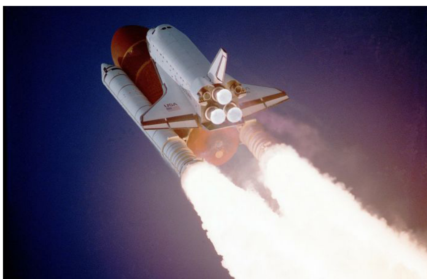
L'External Tank – Serbatoio Esterno – dello Space Shuttle contiene idrogeno e ossigeno liquidi utilizzati in fase di decollo.
